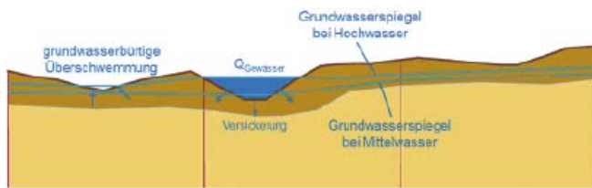
Abb. 2: Wasserspiegel bei gekoppeltem Grundwasser- und Oberflächenwasser-Modell
